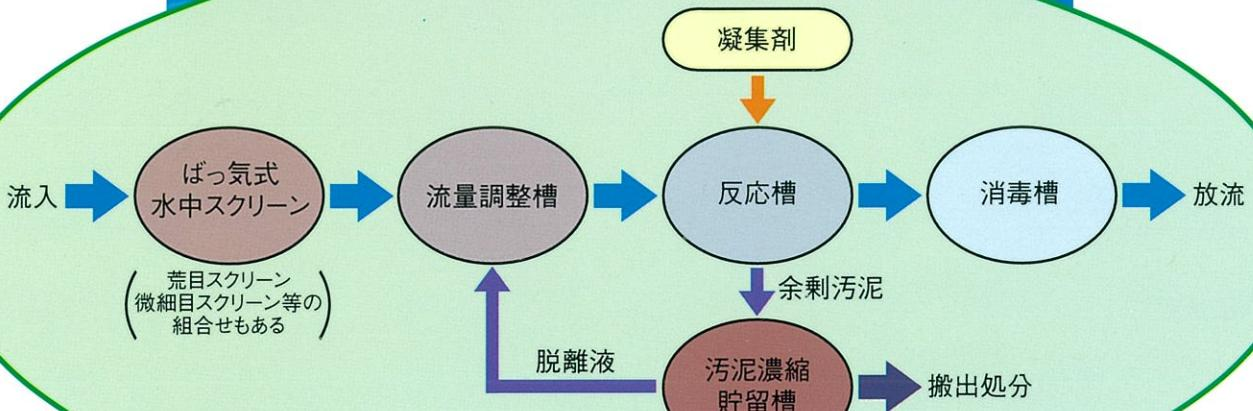
●51～500人槽の代表例、501人槽以上については、汚泥濃縮貯留槽が汚泥濃縮槽と汚泥貯留槽に分割。
